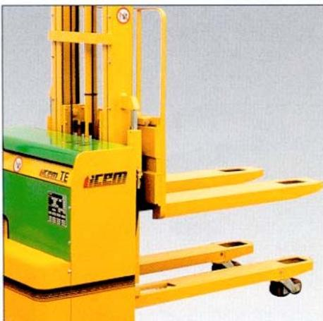
Version TE-DS mit Radarmhub für die Übersteigung von Rampenübergängen.
